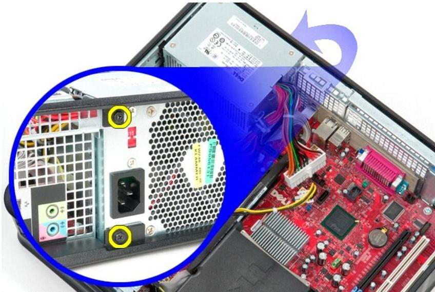
9. Premere la chiusura a scatto dell'alimentatore sul fondo del telaio e far scorrere l'alimentatore verso la parte anteriore del computer.
