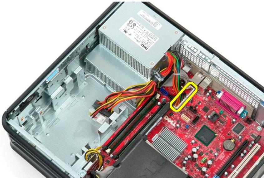
6. Scollegare il connettore dell'alimentazione del processore dalla scheda di sistema.
