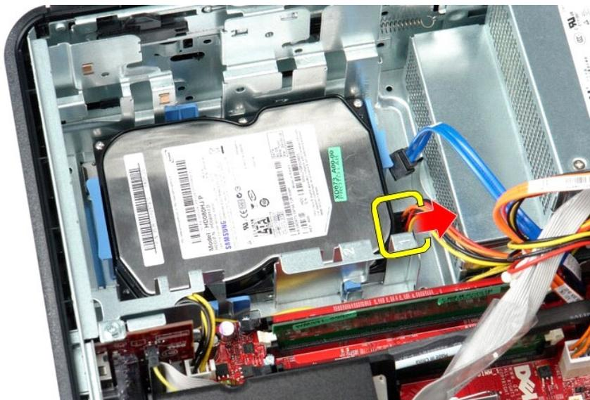
5. Premere verso l'interno sulle due linguette di fissaggio blu posizionate su ciascun lato dell'unità e fare scorrere l'unità verso la parte posteriore del computer.
